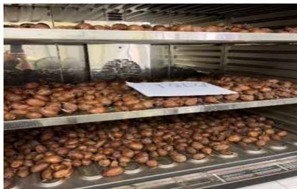
Hệ thống sấy thảo quả được nhóm nghiên cứu chế tạo
